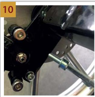
**NL** Schroef de achterste inbusbout (deze is in stap 2 is verwijderd en zit het dichtst bij de as) vast met een inbussleutel.
