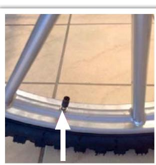
**NL** Zorg ervoor dat uw banden op de juiste spanning zijn, zodat uw dier niet te zwaar hoeft te trekken en uw Sulky niet zwaarder wordt dan nodig.
