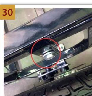
**NL** Monteer de bankbeugels aan beide zijden op het frame met de M8x50 bouten.
