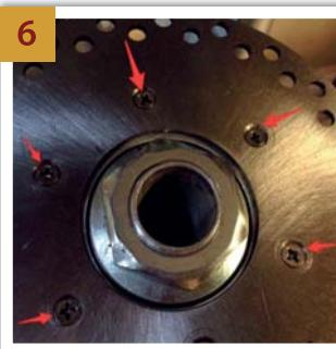
**NL** Controleer of de schroeven, bouten en moeren op de remschijf goed zijn aangedraaid!
