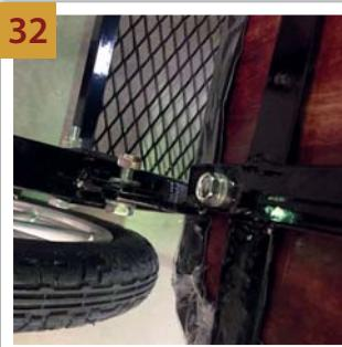
**NL** Monteer de zitting aan de voorzijde met de 2 korte M8x25 bouten, ringen en moeren. Draai de bouten net niet strak aan zodat het bankje kan veren.
