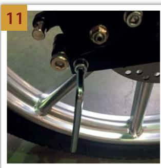
**NL** Schroef de andere inbusbout weer vast (deze is in stap 3 los gedraaid).
