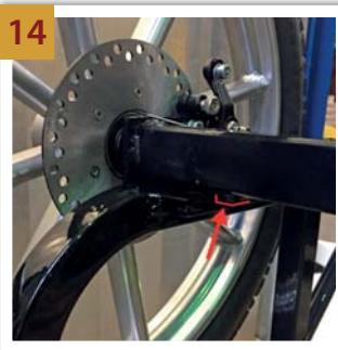
**NL** Leg de as op het frame. Zorg ervoor dat de nokjes aan de onderkant van de as zitten, tegen de bevestigingsplaat.
